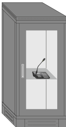
Rys. 2. Wariant 1 – mikrofon umieszczony w szafie DSO.
