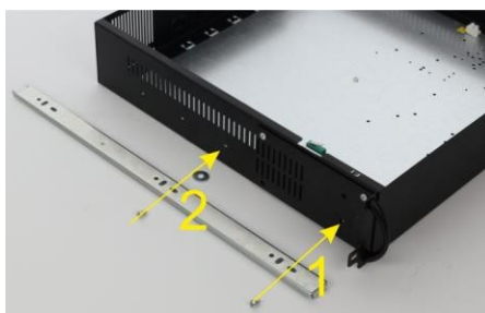
Připevněte jezdec dvěma šrouby ke skříně ARAD (nezapomeňte na distanční podložku pod druhým šroubem).
