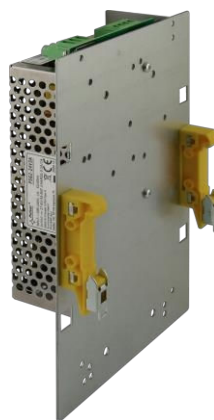
Obr. 2. Příklad montáže napájecího zdroje.
