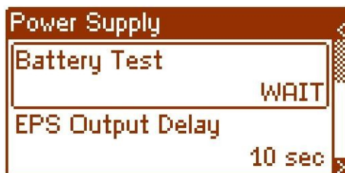
Obr. 28. Dočasná zkušební blokáda baterie.
