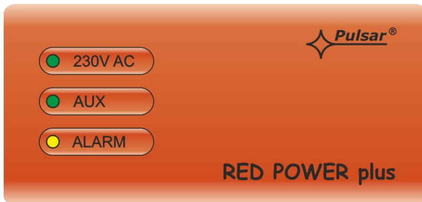
Obr. 6. LED signalizace stavu zdroje.
