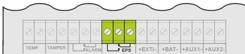
Obr. 8. EPS technický výstup.
