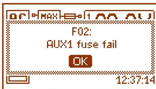
Obr. 18. Zpráva indikující přepálenou pojistku na výstupu AUX1.
