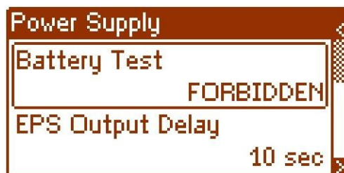
Obr. 30. Test baterie - "ZAKÁZÁNO".
