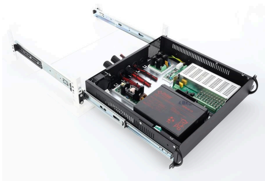
Gehäuse mit Schiebern in die im 19"-RACK-Schrank installierten Schienen einschieben
