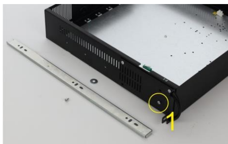
Entfernen Sie die erste M4-Schraube vom ARAD-Gehäuse
