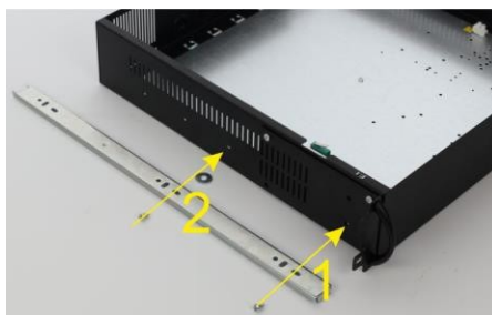
Befestigen Sie die Schieber mit zwei Schrauben am ARAD-Gehäuse (vergessen Sie nicht die Unterlegscheibe unter der zweiten Schraube)
