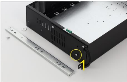
Entfernen Sie die erste M4-Schraube vom ARAD-Gehäuse
