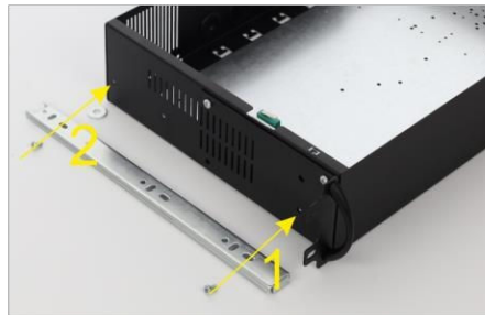
Befestigen Sie die Schieber mit zwei Schrauben am ARAD-Gehäuse (die Distanzscheibe unter der zweiten Schraube nicht vergessen)
