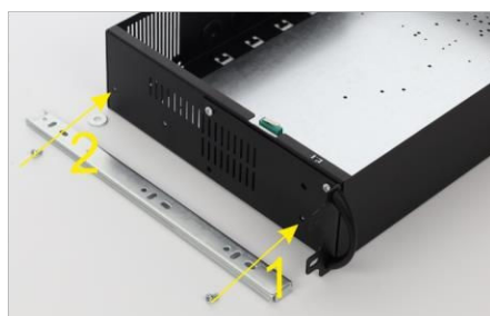
Befestigen Sie die Schieber mit zwei Schrauben am ARAD-Gehäuse (vergessen Sie nicht die Distanzscheibe Unterlegscheibe unter der zweiten Schraube)
