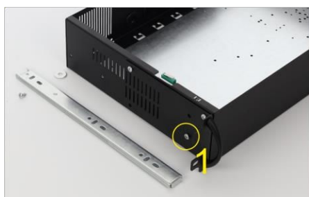
Entfernen Sie die erste M4-Schraube vom ARAD-Gehäuse
