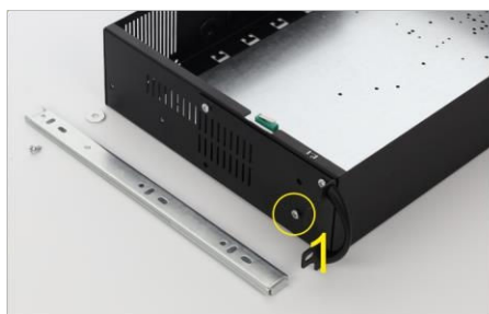
Entfernen Sie die erste M4-Schraube vom ARAD-Gehäuse
