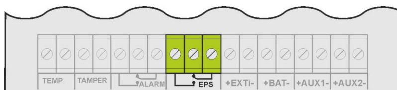
Abb. 8. Technischer Ausgang EPS.
