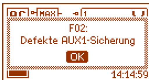
Abb. 18. Die Nachricht signalisiert das Durchbrennen der Sicherung am Ausgang AUX1.
