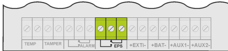
Abb. 7. Technischer Ausgang EPS.
