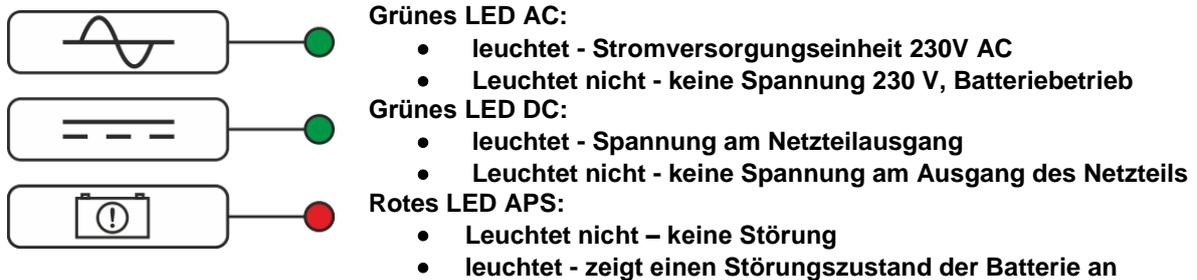
Darüber hinaus ist das Netzteil mit einer Diode auf der Leiterplatte des Netzteilmoduls ausgestattet, die das Anliegen der Spannung am Netzteil Ausgang anzeigt.
