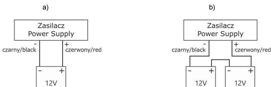
Abb. 5. Anschluss der Batterien je nach Spannungsversion des Netzteils:
