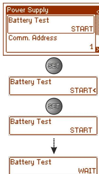
Das Netzgerät verfügt über einen Softwareschutz gegen zu häufiges Testen der Batterien, was zu einer Unterladung führen könnte. Der Schutz besteht darin, dass die Option zur Durchführung des Tests 60 Sekunden lang blockiert wird, nachdem sie zuletzt aktiviert worden ist. In einer solchen Situation erscheint die Meldung "WAIT" auf der LCD-Anzeige im Menü Einstellungen -> PSU -> Batterietest.
