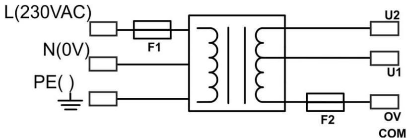
Bild.1. Schaltplan Netzteil.
