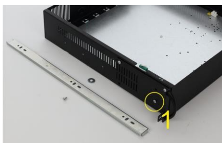
Retirez la première vis M4 du boîtier ARAD
