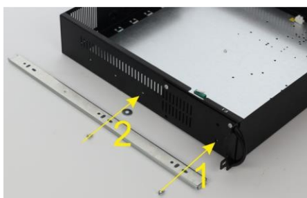
Fixer les glissières à l'aide de deux vis sur l'armoire ARAD (ne pas oublier la rondelle d'écartement sous la deuxième vis).
