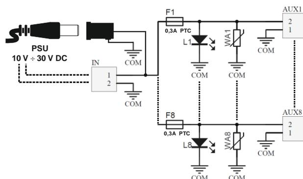
Fig.2. Schéma électrique.
