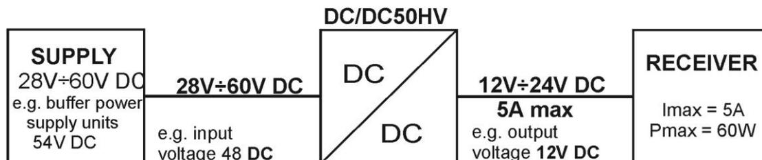
Réglage de la tension de sortie 12÷24V DC, 5A max.
