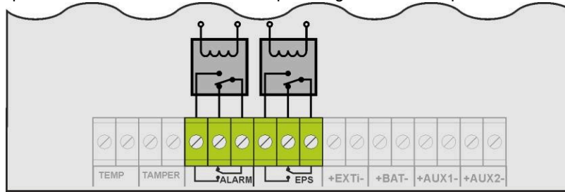
Fig. 7. Schéma électrique des sorties de relais.
