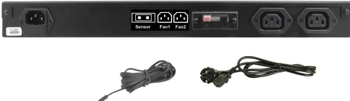
Connectez le capteur de température à la prise "Sensor" située à l'arrière de l'appareil et branchez le cordon d'alimentation 230 V CA à la prise "Power". Branchez les panneaux de ventilation RAWP / RAWP-1 / et RAW1 / RAW2 aux prises Fan1 et Fan2 (type C13) à l'aide des câbles d'alimentation appropriés. Allumez l'appareil à l'aide de l'interrupteur situé sur le panneau avant. Après la mise en marche de l'appareil, la température actuelle mesurée par le capteur s'affiche.
