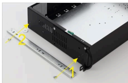
Στερεώστε τους ολισθητήρες με δύο βίδες στο περίβλημα ARAD (μην ξεχάσετε το διαχωριστικό κάτω από τη δεύτερη βίδα)
