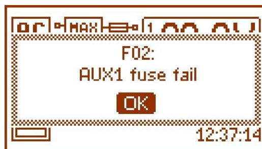
Εικ. 18. Μήνυμα που υποδεικνύει καμένη ασφάλεια στην έξοδο AUX1.
