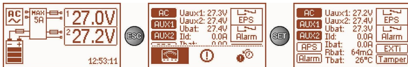
Εικ. 17. Πίνακας LCD – παράμετροι PSU.
