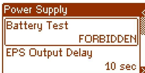
Εικ. 30. Δοκιμή μπαταρίας – «ΑΠΑΓΟΡΕΥΜΕΝΗ».
