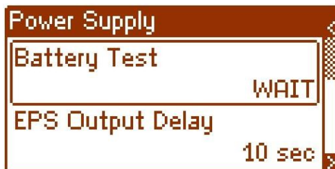
Εικ. 28. Προσωρινός αποκλεισμός δοκιμής μπαταρίας.
