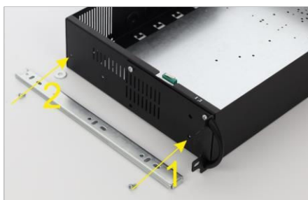
Rögzítse a csúszkákat két csavarral az ARAD burkolathoz (ne felejtse el a távtartót alátétet a második csavar alatt)
