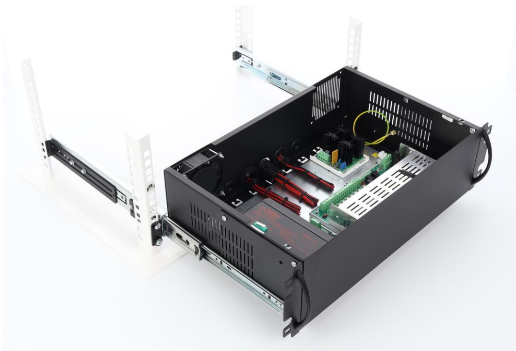
Csúsztassa a szekrényt a csúszkákkal a 19"-os RACK szekrénybe szerelt sínekbe.
