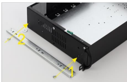
Rögzítse a csúszkákat két csavarral a ARAD burkolat (ne felejtse el a második csavar alatti távtartó alátétet)
