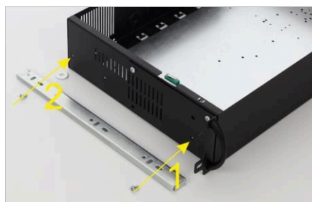
Rögzítse a csúszkát két csavarral az ARAD burkolathoz (ne felejtse el a távtartót alátétet a második csavar alá)
