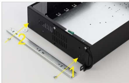
Rögzítse a csúszkát két csavarral a ARAD burkolat (ne felejtse el a második csavar alatti távtartó alátétet)
