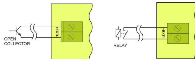
6. ábra. Példák a csatlakozásokra.
