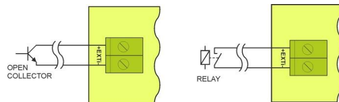
6. ábra: Csatlakozási példák.
