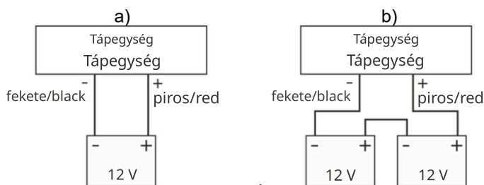
4. ábra: Az akkumulátorok csatlakoztatása a tápegység feszültségváltoztatótól függően: a) 2 V-os változat, b) 24 V-os változat,
