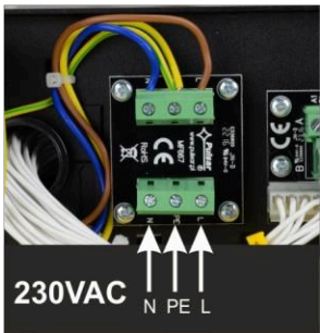
Scheda di alimentazione PCB nel pannello di permutazione
