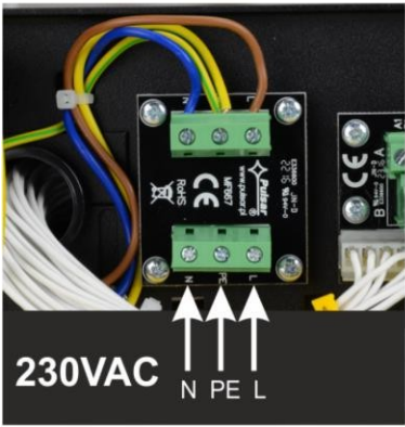
Scheda di alimentazione PCB nel pannello di permutazione retrattile
