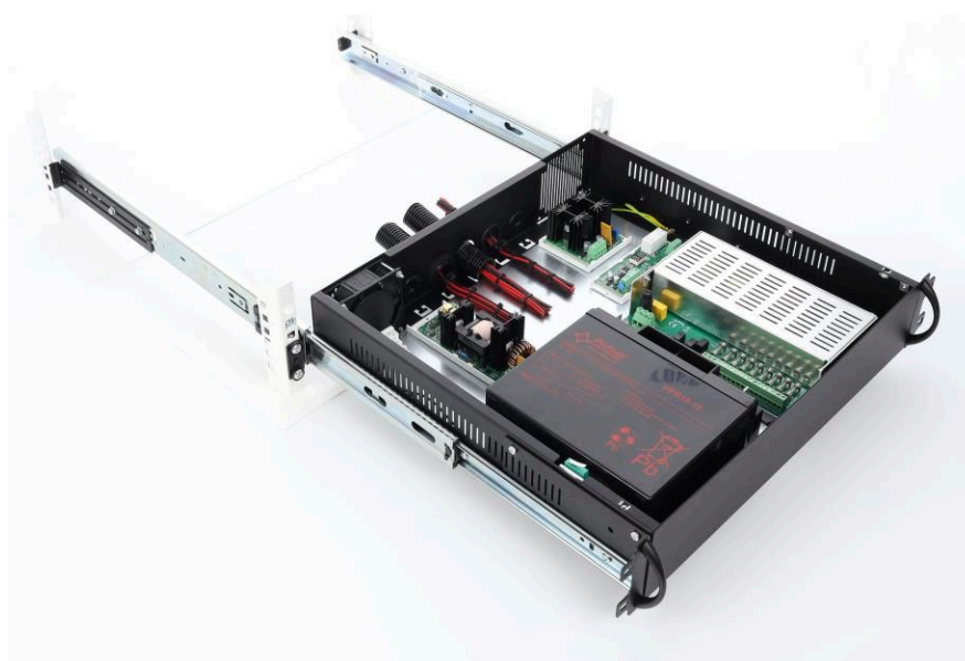
Inserire l'involucro con i cursori nelle guide installate nell'armadio RACK da 19".
