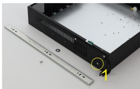
Rimuovere la prima vite M4 dall'involucro ARAD.
