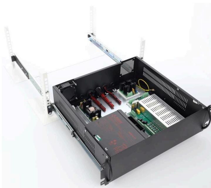
Inserire l'involucro con i cursori nelle guide installate nell'armadio RACK da 19"
