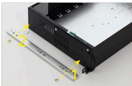
Fissare i cursori con due viti alla all'involucro ARAD (non dimenticare la rondella distanziatrice sotto la seconda vite)
