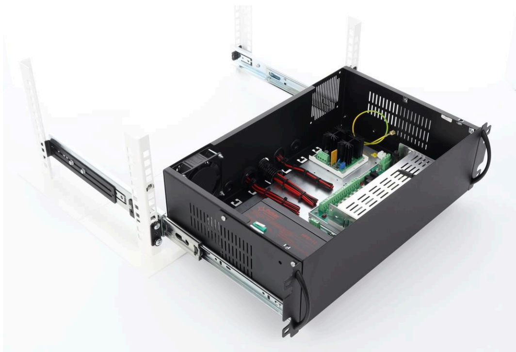
Far scorrere l'involucro con i cursori nelle guide installate nell'armadio RACK da 19"
