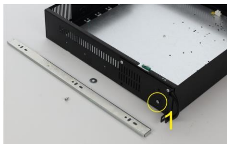
Rimuovere la prima vite M4 dall'involucro ARAD.
