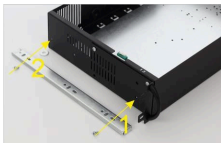
Fissare i cursori con due viti alla custodia ARAD (non dimenticare il distanziatore sotto la seconda vite)
