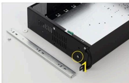
Rimuovere la prima vite M4 dall'involucro ARAD
