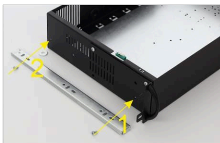
Fissare i cursori con due viti all'involucro ARAD (non dimenticare la rondella distanziatrice sotto la seconda vite)
