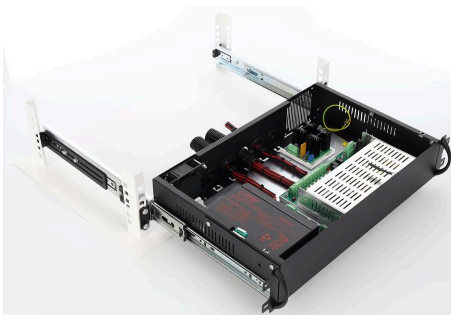
Far scorrere l'involucro con i cursori nelle guide installate nell'armadio RACK da 19"
