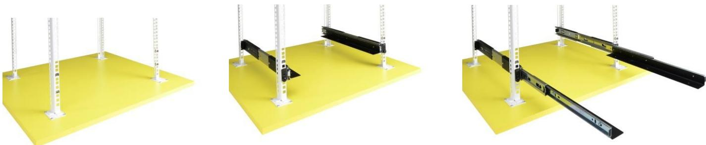
**3.2.** Posizionare l'involucro ARAD sulle guide ARAS scorrevoli. Quindi, fissarlo dall'interno con viti M4 (in dotazione). L'involucro deve essere fissato alla parte anteriore delle guide RACK con quattro viti 4xM6.
