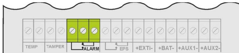
Figura 9. Uscita tecnica ALLARME.
