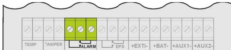
Figura 9. Uscita tecnica ALLARME.
