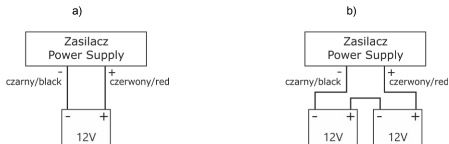
Fig. 5. Collegamento delle batterie in base alla versione di tensione dell'alimentatore: a) alimentatori versione 12V, b) alimentatori versione 24V
