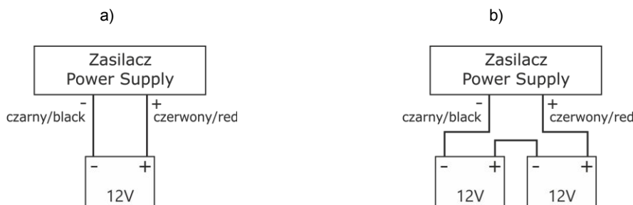
Fig. 5. Collegamento delle batterie a seconda della versione di tensione dell'alimentatore: a) alimentatori versione 12 V, b) alimentatori versione 24 V
