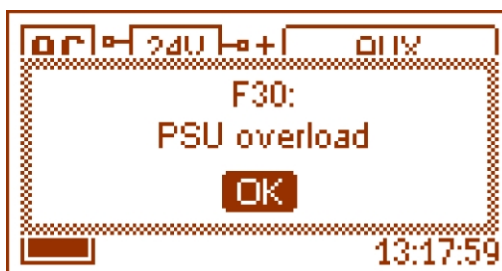
Fig. 14. Informazione relativa al sovraccarico dell'alimentatore.
