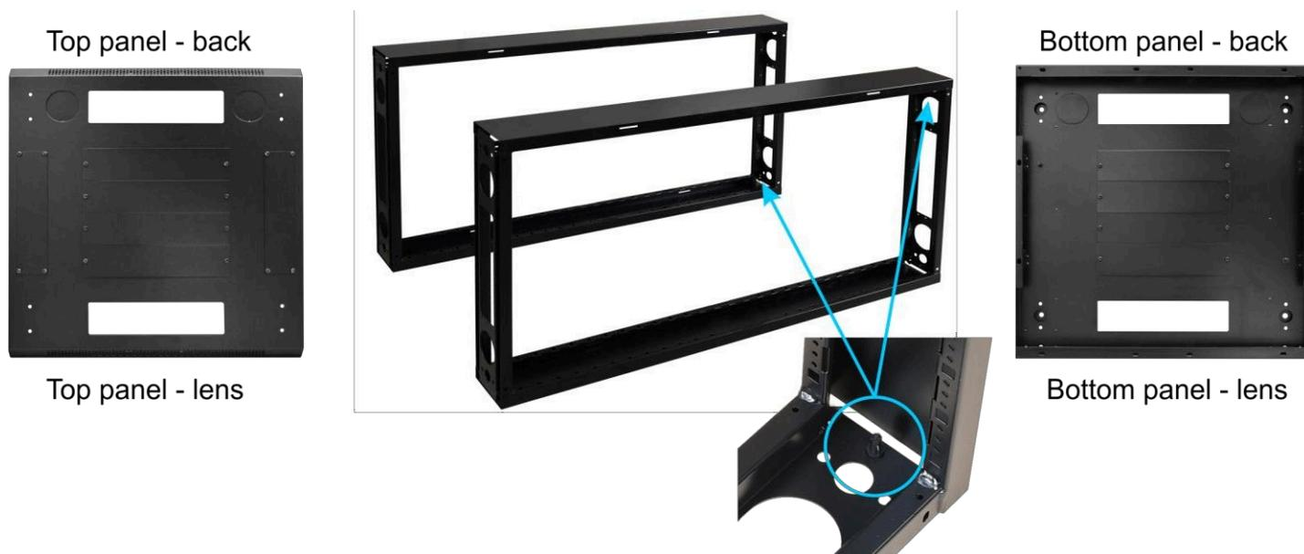
**5.2)** Montare la piastra superiore e la piastra inferiore rispettivamente sul telaio sinistro e destro dell'armadio RACK. Utilizzare viti a testa cilindrica M8X12 con dadi M8 (16 pezzi). Avvitare le **ruote** e le **gambe** del mobile alla piastra inferiore del mobile.
