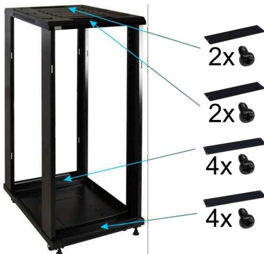
**5.4)** All'interno dell'armadio, installare i profili trasversali e i profili RACK dall'interno (anteriore e posteriore), come mostrato nella figura seguente.
