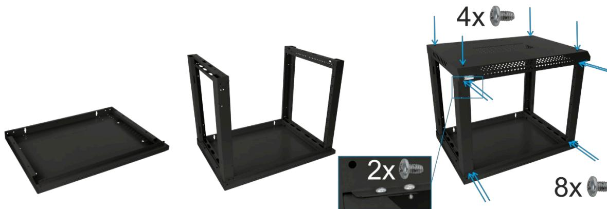
Posizionare l'armadio in modo da poter accedere alla parte posteriore. Avvitare la parte posteriore con 8 viti (due viti per ogni angolo).
