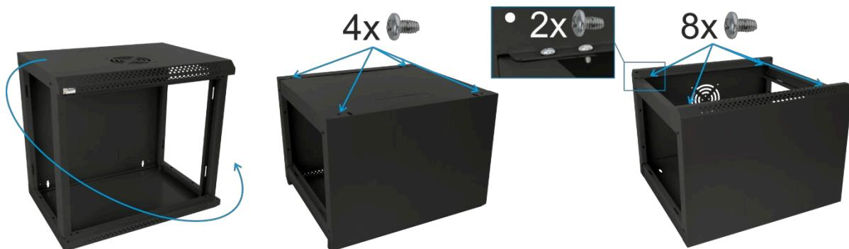
Appoggiare il mobile su un lato e montare i profili RACK con 4 viti (ripetere la stessa operazione appoggiando il mobile sull'altro lato).
