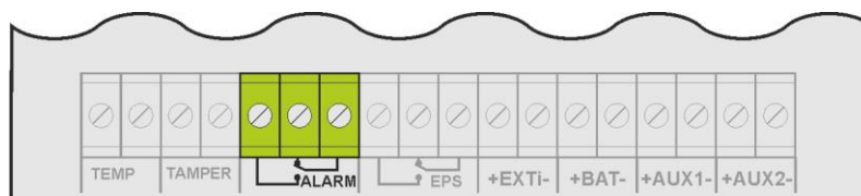
Rys. 10. Wyjście techniczne ALARM.
