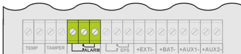
Rys. 9. Wyjście techniczne ALARM.
