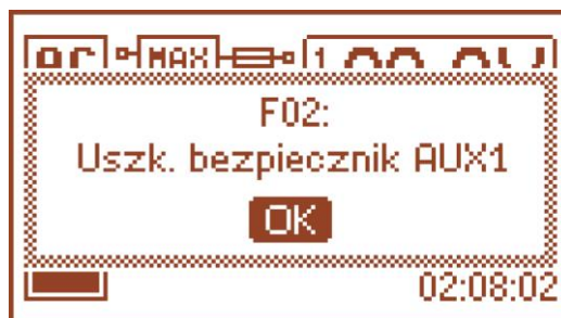
Rys. 18. Komunikat sygnalizujący przepalenie bezpiecznika na wyjściu AUX1.
