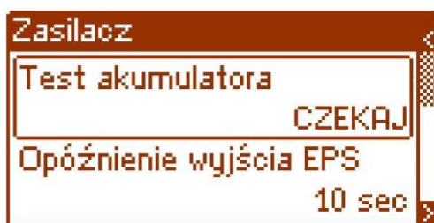
Rys. 28. Czasowe zablokowanie testu akumulatorów.
